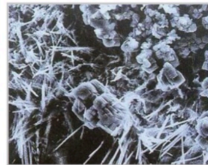
涂刷571防水浆料3天的混凝土结构，混凝土毛细孔道中出现针状结晶体。
