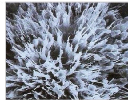
涂刷571防水浆料28天的混凝土结构，混凝土毛细孔道中产生致密的针状结晶体。这种结晶增强了混凝土的密实度，同时切断了水的流动通道。
