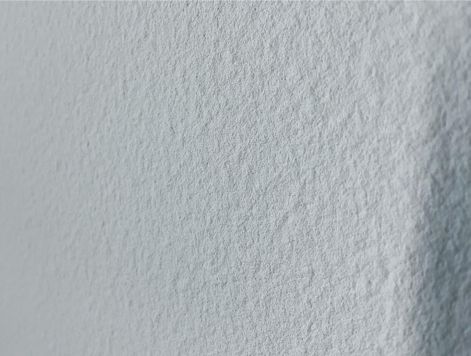
采用硅树脂、硅酸盐及硅溶胶偶联科技与丙烯酸及无机颜料合成的升级版无机涂料，具有无热塑性、不燃、高渗透性、高抗水性、抗静电、耐光不褪色、有机物含量小于5%的矿物砂浆饰面材料。
